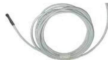
Датчик температуры и влажности воздуха выпускается с сенсором температуры двух модификаций: от +5 до +50 градусов и от -40 до + 50 градусов. Диапазон измерения влажности от 0 до 100% Rh. Напряжение питания 12В. Может монтироваться в монтажную коробку или любой другой компактный бокс. Габариты датчика 38x30мм. Выходной сигнал 0..10 вольт по температуре и 0..10 вольт по влажности.
